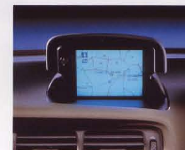
RTI(ロードトラフィックインフォメーションシステム) ※右ハンドル仕様車のみ。3連奏CDプレーヤー内蔵FM/AM付カセットステレオとの同時装着はできません。 設定車種 : V70全タイプ
