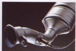
T-5 / 2.5T / 2.5 20V / 2.5 効率的な排出ガスの浄化を可能にする、O 2 センサーと三元触媒コンバーター。
